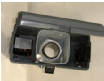
Figura 4: parte superiore della trappola Gravid assemblata.
